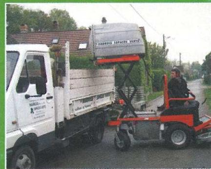
**Malgré une rue étroite, la Dragon 1000 avec son système de braquage zéro permet de vider le bac sans manœuvres supplémentaires. Le collecteur est monté sur un parallélogramme escamotable assurant le levage hydraulique du bac en polyester de 770 litres (mesuré) à la hauteur de 1,90 m avec un déport de 40 cm.**
