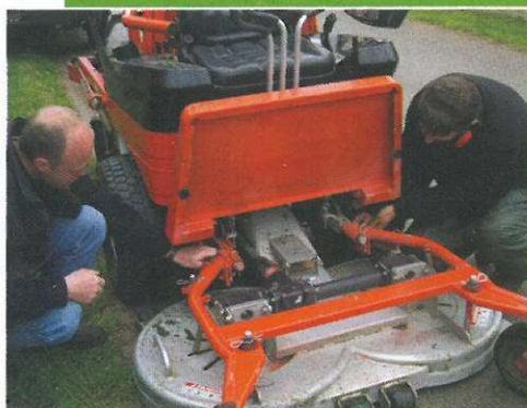
**Le relevage du plateau de coupe est hydraulique, après avoir dételé le carter, il se met en position de service.**
