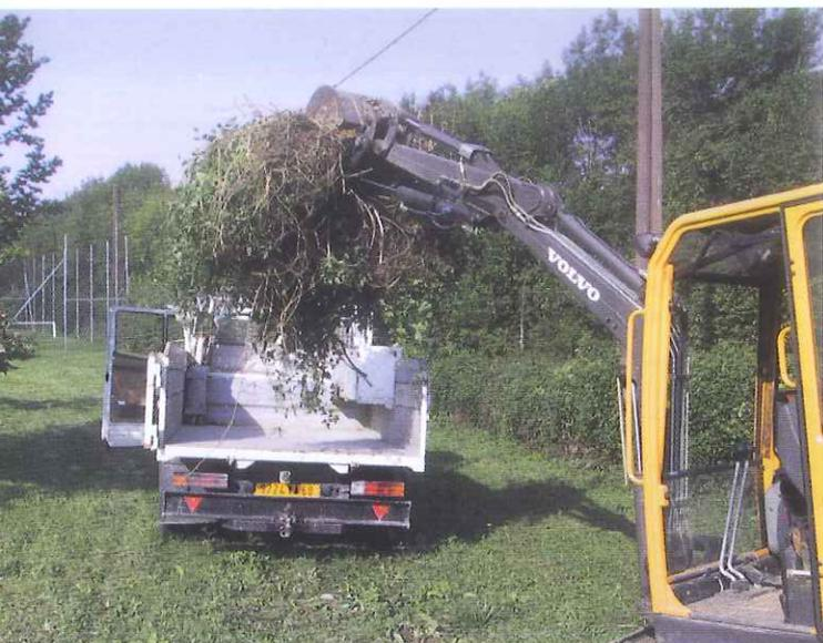
Pour évacuer ses déchets verts sur une partie de ses chantiers, Harrois Espaces Verts les charge dans une benne de camion à l'aide d'une minipelle munie d'une pince hydraulique.
