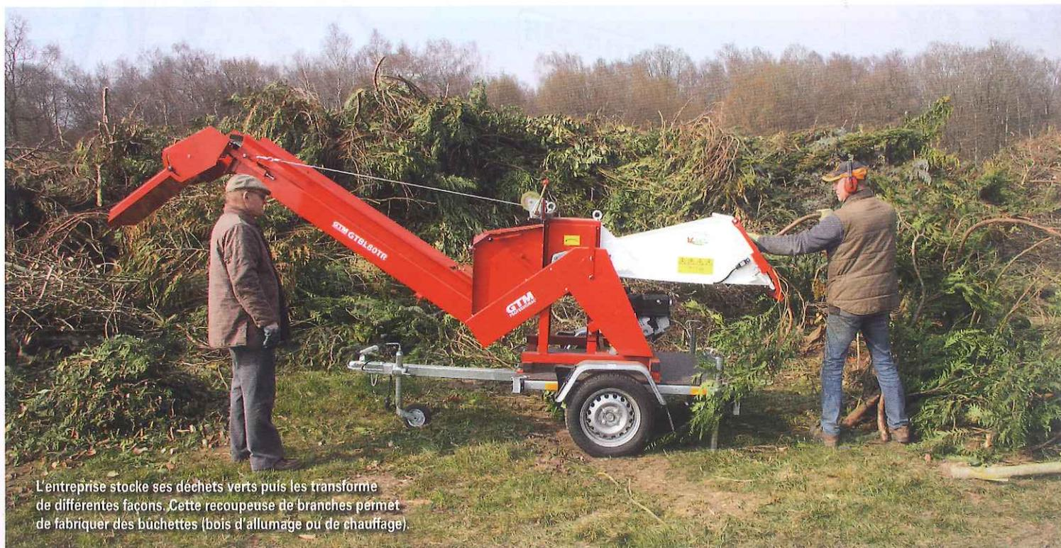
L'entreprise stocke ses déchets verts puis les transforme de différentes façons. Cette recoupeuse de branches permet de fabriquer des bûchettes (bois d'allumage ou de chauffage).
