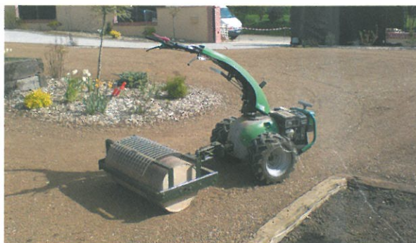
Christophe Harrois utilise un rouleau à gazon sur lequel le conducteur peut monter pour lester la machine de son propre poids et diriger l'engin
